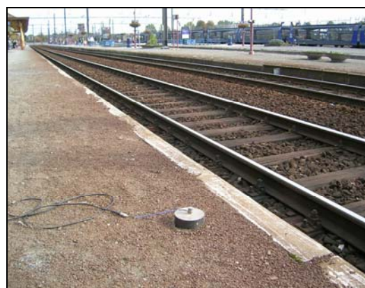
Détermination des déformations dynamiques des planchers causées par le trafic ferroviaire (gare de Ath)
